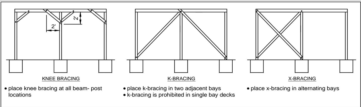
**FIGURE 22: DIAGONAL BRACING AT BEAM-POST LOCATIONS
