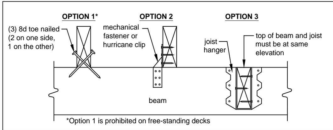
FIGURE 8: JOIST-TO-BEAM DETAIL
