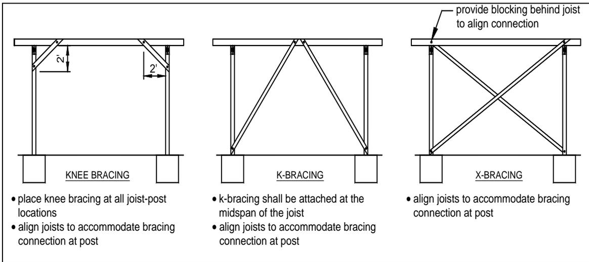
**FIGURE 23: DIAGONAL BRACING AT JOISTS-POST LOCATIONS
